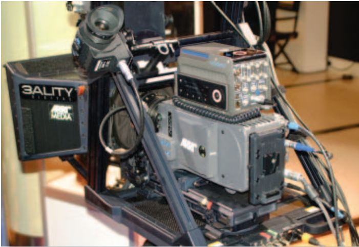
Камеры ARRI Alexa с рекордерами Codex, установленные в стереоплатформу Zality Digital
